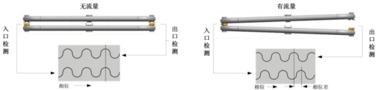
图 1 质量流量计测量原理
